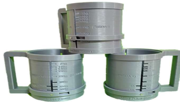
Smart Cup Fertilizer pada tahap uji cuba 3, menggunakan kaedah 3D printing.
